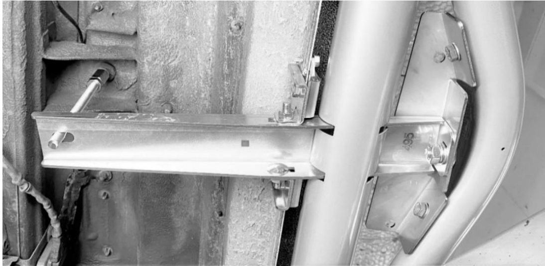
Kuva 2.9 Oikea puoli. Astinsivuputken asennus
